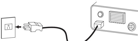
電源コンセントはアース付き3極タイプを使用し、確実にアースをしてください。振動子に高電圧が加えられていますので、水濡れや本機のトラブルで漏電した場合には感電の恐れがあります。ガス管を使用してのアースはしないでください。
