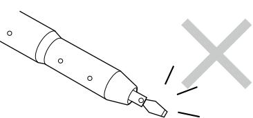
各ハンドピースに指定された刃以外は使用しないでください。刃が折れて飛ぶことがあります。発振中は絶対に刃に触らないでください。また、発振停止中の取扱いにも十分にご注意ください。
