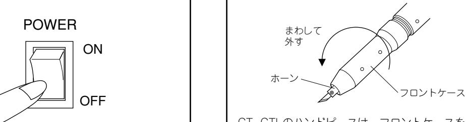
CT、CTLのハンドピースは、フロントケースを回して外し、ケースとホーン間の清掃を定期的に行ってください。（必ず電源を切り、ホーンが十分冷えていることを確認してから行ってください。）
