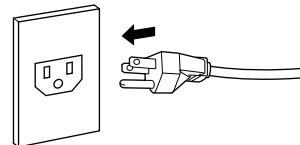
アース付3極タイプの電源コンセントを使用し、確実にアースをしてください。振動子に高電圧が加えられておりますので、水濡れや本機のトラブルで漏電した場合には感電の恐れがあります。なお、ガス管を使用してのアースはしないでください。
