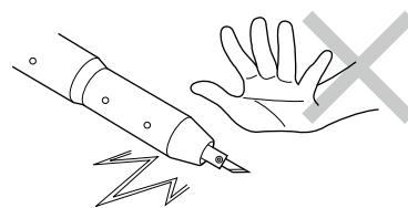
ハンドピースは発振中および発振停止後すぐは、ホーンの内部摩擦により熱を持ちます。特にプラスチック等をカットした後はさらに温度が上がっていますので、ホーン先端および刃には触れないでください。
