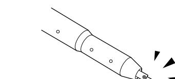
ハンドピース先端より異音がする場合は、ホーン先端の溝内で刃が折れていったり、刃の締付けビスの締付けトルクが不足していることがあります。一旦、電源を切ったうえで点検をしてください。
