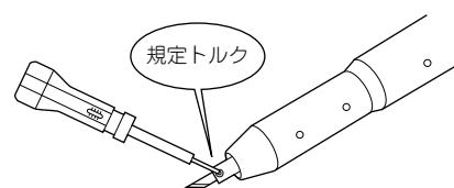
刃の固定用ビスは規定トルクにて締めてください。刃を締めすぎた場合、刃が折れて飛び出しがあります。けがをする恐れがあります。
