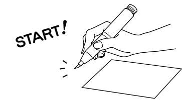
本機は先端に何かが接触していると発振開始ができるにくい回路になっているため、カットの途中での再発振や刃にプラスチックかす等が付着した状態での発振ができない場合があります。一旦、電源を切ったうえで接触物や付着物を取り去ってから作業を開始してください。
